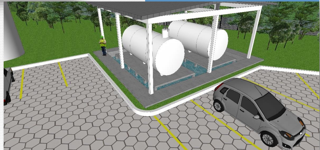
Reservatório de Cloreto Férrico
