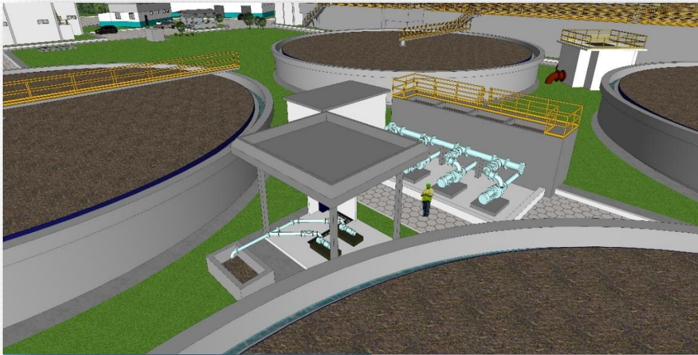
Elevatórias de Escuma e Purga de Lodo
