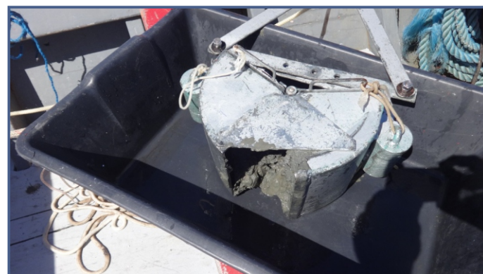
Draga Van-Veen utilizada para coleta de sedimento no mar
