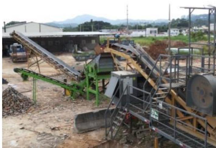
EQUIPAMENTO PARA BRITAGEM DE ENTULHO DA CONSTRUÇÃO CIVIL E A SEPARAÇÃO POR GRANULOMETRIA ATRAVÉS DE PENEIRAS
