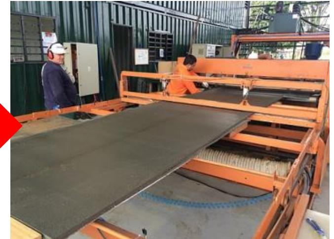
O PLÁSTICO RECICLADO É TRANSFORMADO EM PLACAS, MATÉRIA PRIMA DO SISTEMA INFRAVIAS
